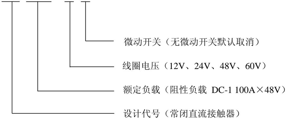
例: BZJ-100D/48; 表示: 常闭直流接触器, DC-1 负载下额定电流为 100A, 线圈电压 DC48V 。
